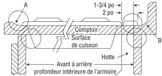
Consulter le guide d'installation de la surface de cuisson pour les dimensions de celle-ci, de la découpe du dessus de comptoir et des exigences pour l'armoire. Les modèles 2730 et 2736 s'installent dans la plupart des armoires standards de 30 po et 36 po de largeur.
