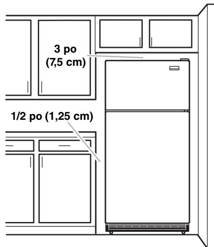
Pour obtenir une aération appropriée pour votre réfrigérateur, il est recommandé de laisser un espace de 1/2 po (1,25 cm) de chaque côté et au sommet du réfrigérateur. Laisser un espace d'au moins 1 po (2,54 cm) entre l'arrière de l'appareil et le mur (le condensateur représente l'arrière, s'il est présent). Si le réfrigérateur comporte une machine à glaçons, s'assurer de laisser un espace additionnel à l'arrière pour les raccordements du conduit d'eau.
