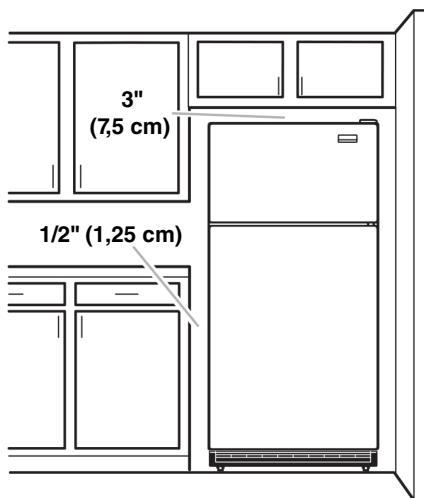
Para asegurar la adecuada ventilación para su refrigerador, se recomienda dejar un espacio de 1/2" (1,25 cm) a cada lado y en la parte de arriba del refrigerador. Deje un espacio de 1" (2,54 cm), como mínimo, entre la parte posterior del gabinete y la pared (considere el condensador como parte posterior si está presente). Si el refrigerador tiene fábrica de hielo, asegúrese de dejar espacio adicional atrás para las conexiones de la línea de agua.
