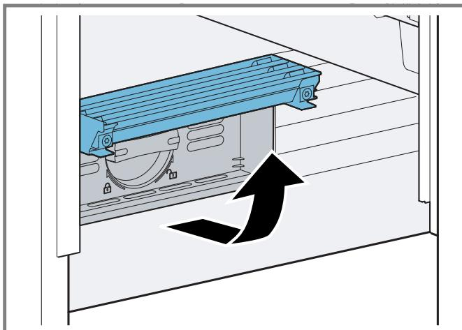
2. Tournez le filtre à eau de 90° dans le sens inverse des aiguilles d'une montre ① et retirez ②.
