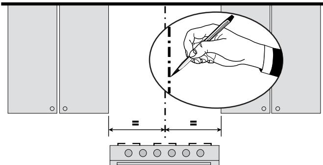
Tracez une ligne verticale sur le mur d'appui le plus haut que possible, au centre de l'emplacement où la hotte sera installée. Tracez une ligne horizontale à l'endroit correspondant au bas de la hotte comme représenté dans l'illustration. Cet emplacement doit se trouver à au moins 24" de la surface de cuisson, si elle est électrique, ou à 30" si elle est au gaz.
