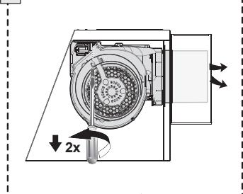
Después de retirar el ventilador, gire como se muestra hasta que esté en la posición correcta de ventilación trasera como se muestra en la Imagen b-c.
