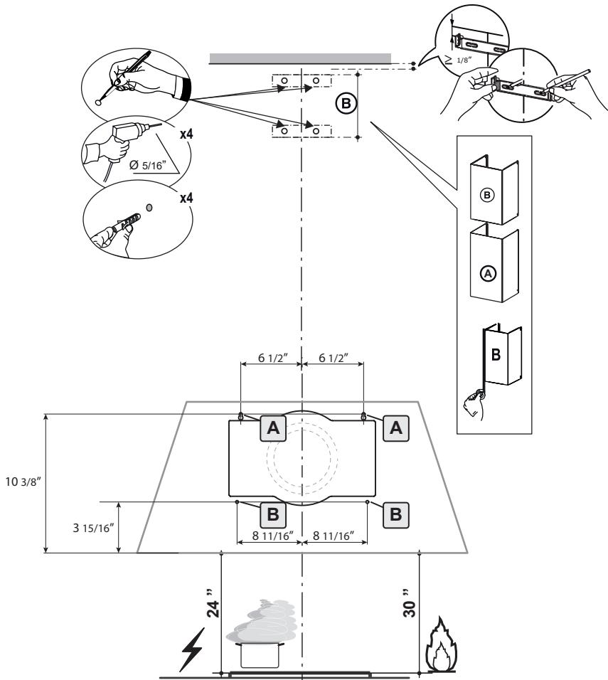
Marque la pared donde se indica (A), 10 3/8" por encima de la línea horizontal y a una distancia de 6 1/2" a la izquierda y derecha de la línea vertical. Comprobando que las dos marcas estén niveladas.
