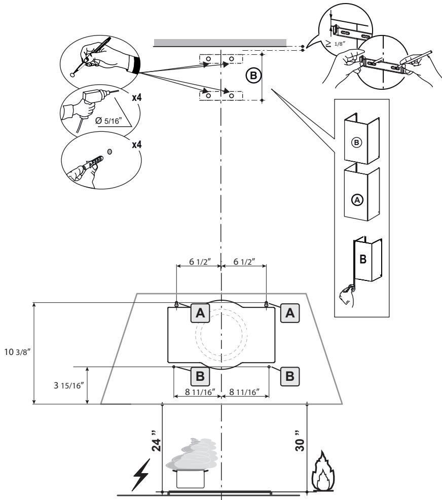
Tracez un repère sur le mur à l'endroit indiqué (A), 10 3/8" au-dessus de la ligne horizontale et à une distance de 6 1/2" à droite et à gauche de la ligne verticale. Vérifiez si les deux marques sont à égalité.
