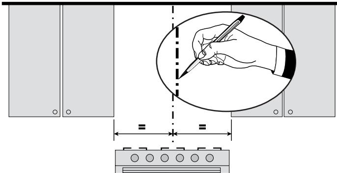
Dibuja una línea vertical en la pared de soporte tan alto como sea posible, en el centro del área donde se instalará la campana. Dibuja una línea horizontal en donde se ubicará el borde inferior de la campana como se indica en la figura que está a un mínimo de 24" sobre la superficie de cocción eléctrica y 30" sobre la de gas.
