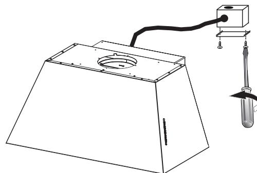
Tirez le câble de l'alimentation par le trou permettant le raccord électrique du boîtier de connexion.
