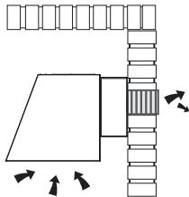
Avant de fixer le bâti de la hotte sur la section arrière, dévissez les 2 vis fixant le ventilateur. Cette mesure simplifiera le raccord de la canalisation de sortie d'air.
