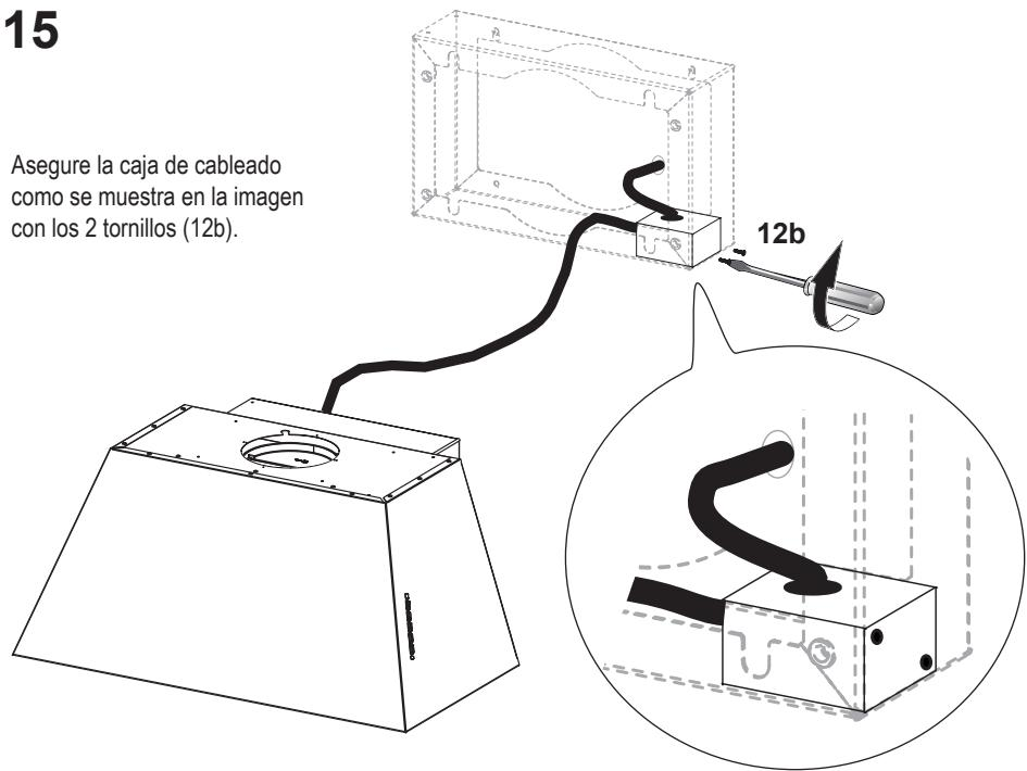
**Atención:** Despues de la instalación de la caja de cableado, coloque el cable dentro de una sección posterior sin tirarlo demasiado.
