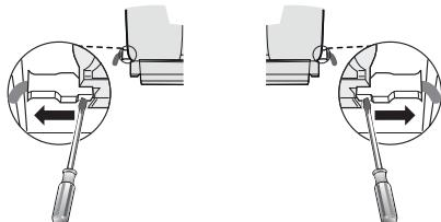
Desde el interior de la campana, utilice un destornillador de cabeza plana, como se muestra en la imagen de arriba, para desconectar los conectores izquierdo y derecho del ventilador.
