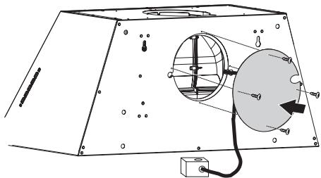
Fixez la plaque de recouvrement à l'aide des 4 vis retirées précédemment et faites passer le fil du boîtier de connexion à l'extérieur du bâti de la hotte par l'encoche de la plaque de recouvrement.
