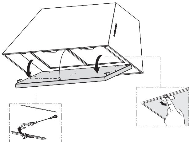
Ouvrez le panneau et dégagiez le câble de retenue comme illustré. Retirez les filtres, en poussant simultanément le levier vers l'arrière de l'appareil et en tirant vers le bas. Ne jetez pas les filtres, mais conservez-les pour plus tard.
