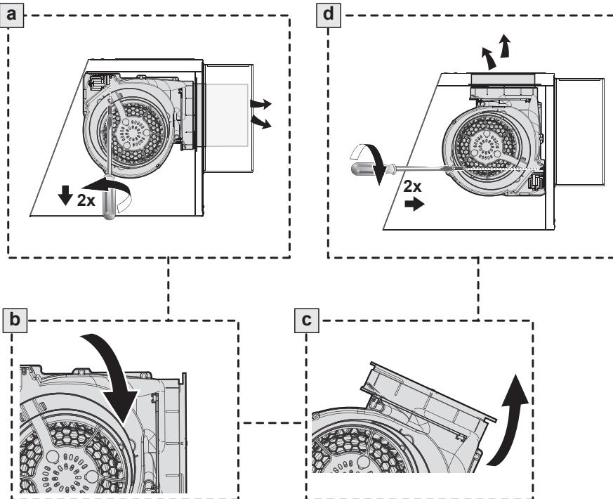
Desatornille los 2 tornillos que sostienen el ventilador y desbloquéelo desde la posición inicial como se muestra en la Imagen a.
