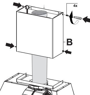
Asegure los lados a los soportes con los 4 tornillos.
