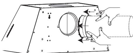
Antes de fijar el cuerpo de la campana a la sección trasera, fije el ventilador en la posición anterior con los mismos dos tornillos.
