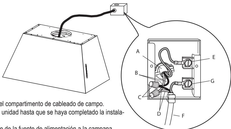
Retire la tapa del compartimento de cableado de campo.
