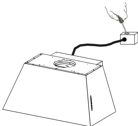
Retirez le couvercle du compartiment du boîtier de connexion en dévissant les deux vis.
