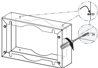
Enganche la sección posterior como se muestra en la imagen de arriba en los tornillos superiores y asegure completamente.
