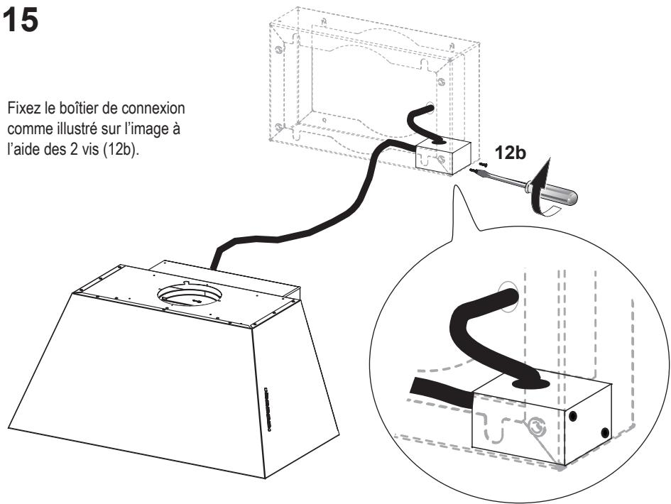
**Attention :** Après l'installation du boîtier de connexion, placez le câble dans une section arrière, sans contrainte sur le câble.
