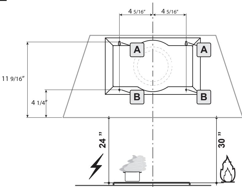
Tracez un repère sur le mur à l'endroit indiqué (A), 11 9/16" au-dessus de la ligne horizontale et à la distance de 4 5/16" à droite et à gauche de la ligne verticale. Vérifiez si les deux marques sont à égalité.
