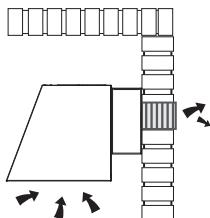
Antes de fijar el cuerpo de la campana a la sección trasera, destornille los 2 tornillos para fijar el ventilador. Esta operación simplificará la conexión del conducto de salida de aire.
