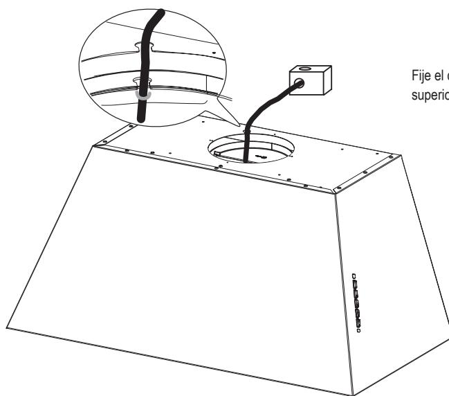
Fije el cable en el orificio en la parte superior de la campana como se muestra.
