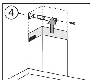
7. Extraire le tube supérieur en le portant jusqu'à l'étrier et le fixer avec les (2) vis. Fig. 4
