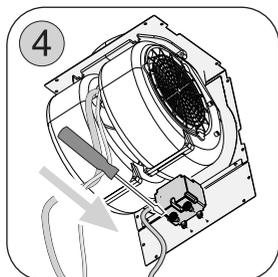
6. Raccordez le connecteur mâle à 6 voies du moteur au connecteur femelle à 6 voies, relié à l'intérieur du corps moteur. Fig.6
