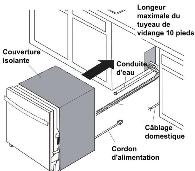
**ASTUCE :** Positionner la ligne d'eau et le câblage sur le sol pour éviter les interférences avec la base du lave-vaisselle.
