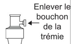
**CONSEIL:** Évitez des frais de service inutiles. Assurez-vous toujours que le bouchon de vidange du broyeur a été retiré avant de fixer le tuyau de vidange du lave-vaisselle au broyeur.
