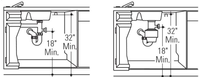
Installer le té de vidange ou le broyeur et l'écart d'air conformément aux instructions du fabricant.
