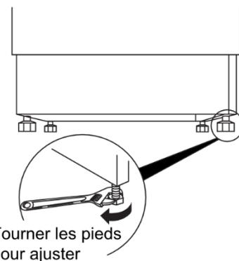
**ASTUCE:** Sortez le panier inférieur, environ à mi-chemin. Vérifiez que le panier ne roule pas vers l'avant ou vers l'arrière dans le lave-vaisselle. Si le panier roule dans l'une ou l'autre direction, le lave-vaisselle doit être remis à niveau.
