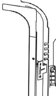
Ouvrez la porte, retirez le capuchon de la cuve des deux côtés de la cuve. Installez la vis à travers le trou latéral du lave-vaisselle jusqu'au mur de l'armoire. Réinstallez le capuchon de la cuve.
