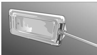
4. Insérer la pointe du tournevis à lame plate, et étroite avec un angle d'environ 40°.
