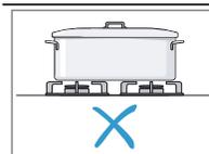
N'utilisez jamais plusieurs brûleurs pour chauffer des ustensiles de cuisine, tels qu'un rôtissoire, une poêle, une pierre à griller. L'accumulation de chaleur qui en résulte endommagera l'appareil.
