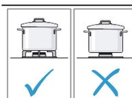
Placez les ustensiles de cuisine sur les grilles du brûleur. Ne placez jamais la batterie de cuisine directement sur le brûleur. Avant d'utiliser l'appareil, assurez-vous que les grilles et les chapeaux des brûleurs sont correctement positionnés.
