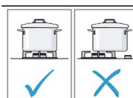
Placez l'ustensile au milieu du brûleur, sinon il risque de basculer. Ne placez pas de gros ustensiles de cuisine sur les brûleurs à proximité des commandes. Les commandes peuvent être endommagées en raison d'une surchauffe.
