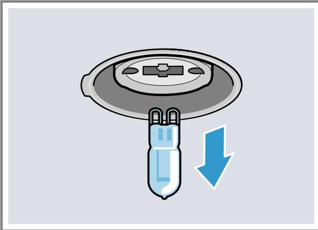
5. Ne touchez pas directement le verre de la nouvelle ampoule de rechange, car l'huile de vos doigts peut provoquer une défaillance prématurée de l'ampoule. Saisissez plutôt l'ampoule de rechange avec un chiffon sec et propre. Repérez les deux tiges dans le support de céramique, en tâtant légèrement jusqu'à ce que les deux tiges s'insèrent dans la douille céramique.
