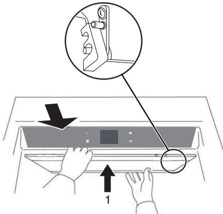
2. S'assurer de brancher les (2) connecteurs électriques du panneau en verre (B) aux connecteurs (A) situés dans les coins supérieurs avant gauche et droit du plafond du réfrigérateur.
