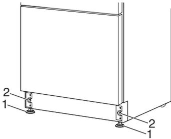
2. Ajuster les pieds de réglage de l'aplomb et établir l'aplomb du réfrigérateur de gauche à droite et d'avant à arrière de façon à ce qu'il soit d'aplomb et aligné avec les armoires.
