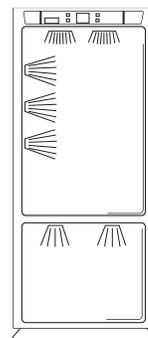
**IMPORTANT** : Les lampes dans le réfrigérateur et le congélateur utilisent la technologie à DEL et n'ont pas besoin d'être remplacées.
