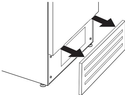
3. Utiliser un aspirateur à brosse douce pour nettoyer la grille, les endroits ouverts derrière la grille et la surface à l'avant du condensateur.
