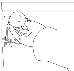
**IMPORTANT :** De l'air piégé dans le système d'alimentation en eau peut entraîner l'éjection de l'eau et du filtre. Toujours faire couler l'eau pendant au moins 2 minutes avant de retirer le filtre ou le bouchon de dérivation bleu.
