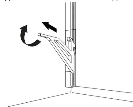
5. Placer la ferrure de support à la hauteur voulue, glisser les ferrures de support des deux côtés. S'assurer que les supports sont placés à la même hauteur.
