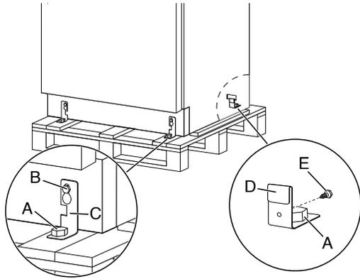
1. Dévisser les quatre boulons (A) à l'aide d'une clé de 3/4 po (19 mm).
