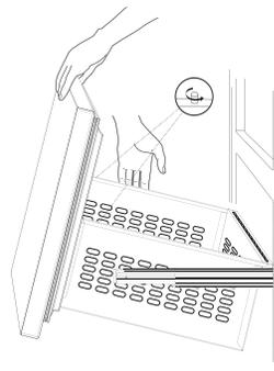
3. Remettre en place et serrer les deux vis à oreilles.
