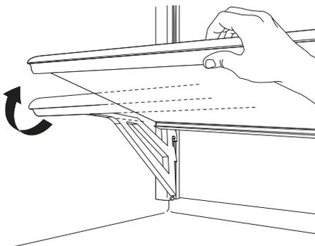
4. Pour régler la hauteur des tablettes en verre, incliner le support vers le haut et tirer sur le support des deux côtés.
