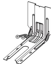
5. À l'aide des deux vis à tête cruciforme no 10 x 15/8 po (4,1 cm) fournies, visser la bride antibascullement au mur ou au plancher.
