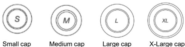
Un chapeau de brûleur correctement placé doit être horizontal. Si les chapeaux de brûleur ne sont pas correctement installés, les brûleurs de surface ne s'allumeront pas. Lorsque le chapeau de brûleur est correctement aligné, il ne balance pas et n'oscille pas.
