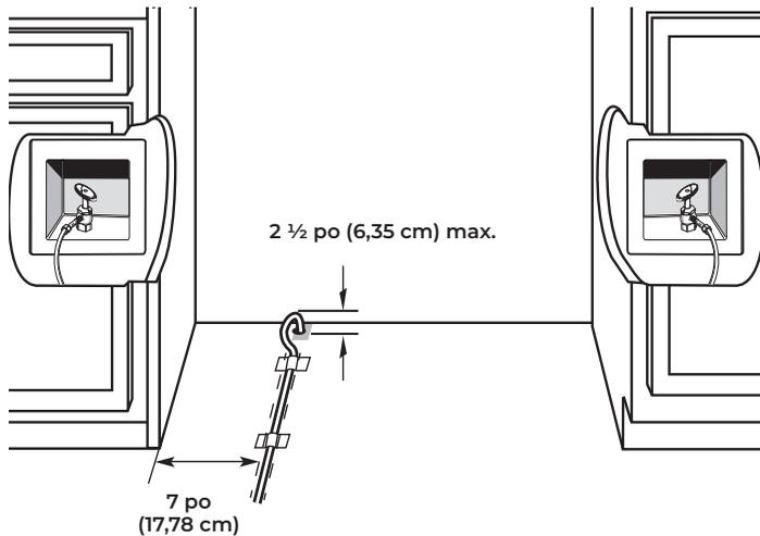
**REMARQUE :** La canalisation flexible d'alimentation en eau, homologuée conformément aux codes en vigueur, doit être raccordée à la vanne d'alimentation par le sol.
