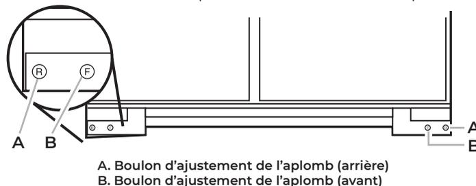
2. Ajuster les pieds de réglage de l'aplomb et établir l'aplomb du réfrigérateur de gauche à droite et d'avant à arrière de façon à ce qu'il soit d'aplomb et aligné avec les armoires.
