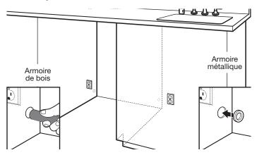
**Armoire de bois :** Poncer l'orifice jusqu'à obtenir une surface lisse. **Armoire métallique :** Couvrir le contour du trou avec l'œillet fourni avec l'ensemble du cordon d'alimentation.
