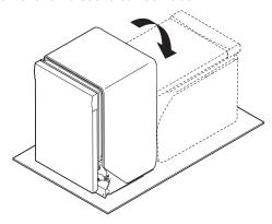
Conseil utile: Retirer tout le matériel d'expédition interne, le tuyau de vidange, la trousse d'installation et la poignée (si incluse), avant de le coucher sur le dos. Ne pas retirer la pellicule de la porte pour le moment.
