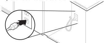
Brancher l'appareil sur une prise à 3 alvéoles reliée à la terre.
