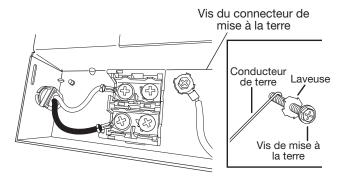
Passer le cordon d'alimentation dans le serre-câbles situé à l'arrière du boîtier de raccordement. Retirer la vis de liaison à la terre du plancher surélevé à l'intérieur du boîtier et la placer à travers la borne en anneau de la vis verte de mise à la terre du cordon d'alimentation. Si le fil ne comporte pas de borne en anneau, plier une boucle au bout du fil. Rattacher et serrer la vis de liaison à la terre sur le plancher surélevé du boîtier.
