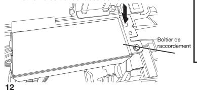
Pour retirer le boîtier de raccordement, appuyer sur le fermoir en plastique, glisser la boîte vers la gauche de l'appareil contre le tube de métal et faire tourner le côté gauche de la boîte vers l'avant. S'assurer que le câblage du produit reste attaché dans le boîtier de raccordement
