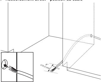
Passer le câble comme indiqué pour un raccordement direct. Ne pas brancher pour l'instant le câble au produit. Ce branchement sera effectué plus tard, une fois que l'appareil sera installé dans l'ouverture de l'armoire.
