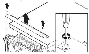
À l'aide d'un tourne-écrou de 5/16 po (7,9 mm), ôter les deux vis fixant les panneaux d'accès au lave-vaisselle. Après avoir enlevé les vis, pousser le panneau d'accès vers le haut du projet pour le déverrouiller, puis l'enlever.
