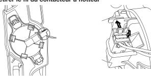
Pour retirer le fil du contacteur à flotteur, pousser doucement sur l'onglet de fermeture du connecteur (1), puis tirer le connecteur (2) à l'extérieur du boîtier. Le flotteur ne devrait pas être enlevé du plateau.
