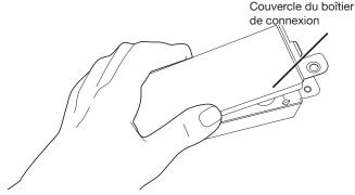
À l'aide d'un tourne-écrou de 1/4 po (6,4 mm), retirer la vis fixant le couvercle du boîtier de raccordement. Retirer le couvercle en le soulevant du boîtier. Conserver le couvercle pour utilisation ultérieure.
