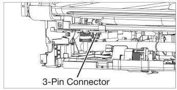
Sur certains modèles, un câble de connexion de service avec connecteur à 3 broches est laissé volontairement débranché et rangé derrière le panneau d'accès. Ce câble est à l'usage du technicien d'entretien.
