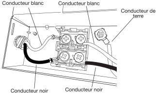
Pour brancher les fils aux cosses rondes, retirer les vis du bornier, passer les vis à travers les cosses rondes, puis les revisser au bornier.
