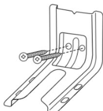
5. À l'aide du tournevis cruciforme, monter la bride antibasculement sur le mur ou sur le plancher avec les deux vis n° #12 x 1 5/8 po (4,1 cm) fournies.
