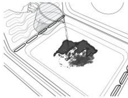
**IMPORTANT :** Ne pas utiliser des produits chimiques ou d'autres additifs avec l'eau. Ne pas ouvrir la porte du four au cours du programme de nettoyage. L'eau au fond du four est chaude.
