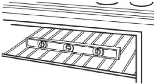
3. Si la cuisinière n'est pas d'aplomb, la tirer vers l'avant jusqu'à ce que le pied de nivellement arrière se dégage de la bride antibasculement.
