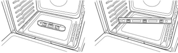
2. Si la cuisinière n'est pas d'aplomb, la tirer vers l'avant jusqu'à ce que le pied de nivellement arrière se dégage de la bride antibasculement.
