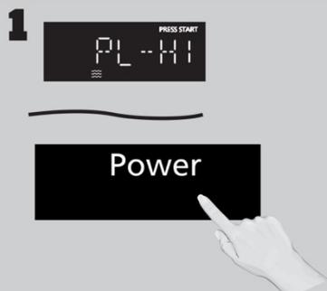
Appuyer sur la touche **Power Level** (niveau de puissance) jusqu'à ce que le niveau souhaité s'affiche. PL--HI correspond au niveau de puissance maximum et PL--0 au niveau de puissance minimum.
