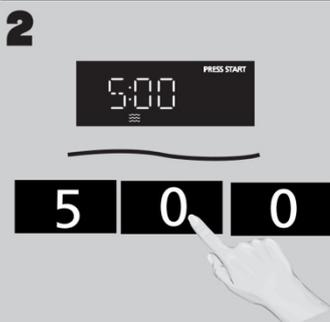
Régler le temps de cuisson à l'aide des **touches numériques**. Le temps de cuisson maximum est de 99 minutes, 99 secondes.
