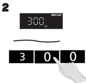
Régler la durée souhaitée à l'aide des **touches numériques** (jusqu'à 99 minutes, 99 secondes).
