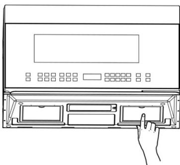
**Retrait et nettoyage des filtres** Pour les retirer, les faire glisser vers l'arrière à l'aide des onglets. Les abaisser et les extraire.
