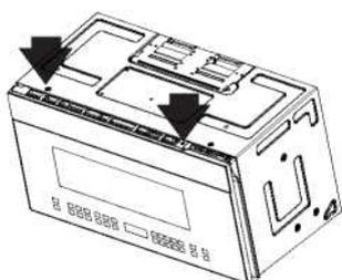
Déposer les 2 vis fixant la grille et dégager la grille.
