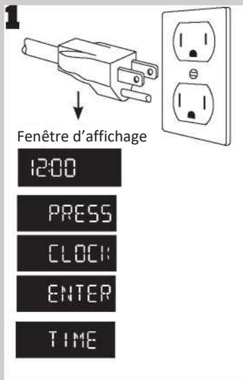
Brancher l'appareil dans une prise correctement reliée à la terre. Le message « 12:00 PRESS CLOCK ENTER TIME » (12:00 saisir l'heure de l'horloge) défile sur l'écran.
