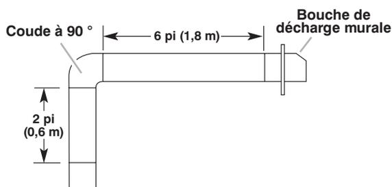
Dans l'exemple suivant, la longueur théorique du circuit se trouve dans les limites du maximum recommandé de 35 pi (10,7 m).
