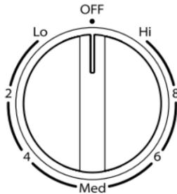
Les boutons de commande peuvent être réglés à n'importe quelle position entre HI (élevée) et LO (basse). Pousser et tourner le bouton jusqu'au réglage choisi.
