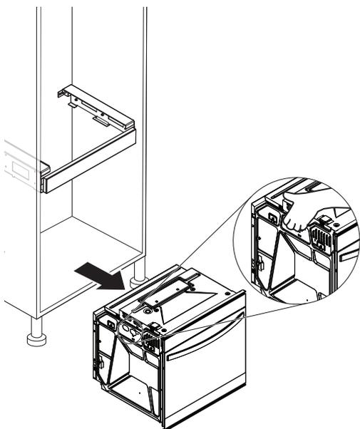
9. À l'aide de deux personnes ou plus, soulever le four supérieur par les poignées latérales situées de chaque côté du four. Insérer le four doucement dans l'ouverture de l'armoire, en le faisant glisser sur les supports gauche et droit.
