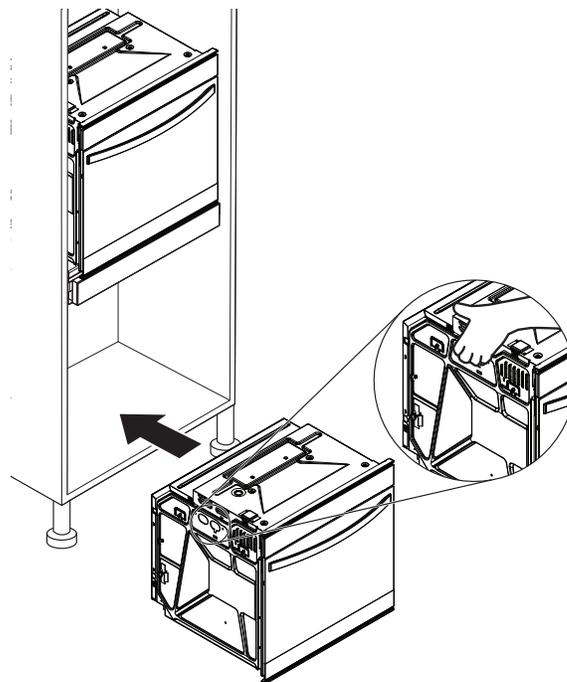
2. Pousser contre la zone du joint de l'avant du châssis pour pousser le four dans l'armoire.
