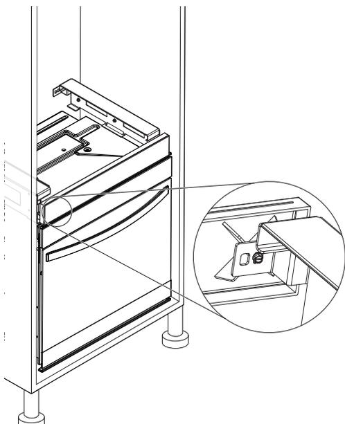
8. À l'aide de deux personnes ou plus, retirer délicatement le four inférieur à l'extérieur de l'armoire à l'aide des poignées situées sur les côtés droit et gauche du four.
