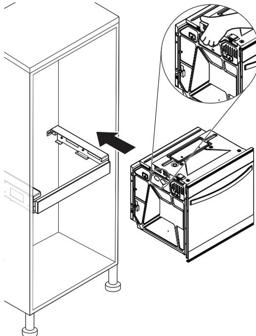
10. Pousser contre la zone du joint de l'avant du châssis pour pousser le four dans l'armoire.
