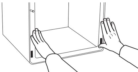
11. À l'aide de deux personnes ou plus, déplacer doucement le four inférieur par les poignées latérales situées sur les côtés droit et gauche du four et le placer sur le sol près de l'ouverture de l'armoire.
