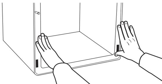
3. Fixer solidement le four à l'armoire au moyen des vis autotaraudeuses de 4 x 25 mm fournies (1 de chaque côté). Insérer les vis à travers les trous des glissières de montage. Ne pas serrer excessivement les vis.
