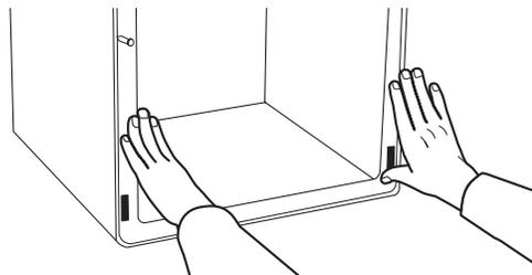
3. Fixer solidement le four à l'armoire à l'aide des deux vis autotaraudantes de 4 x 25 mm fournies. Insérer les vis à travers les trous des glissières de montage. Ne pas serrer excessivement les vis.
