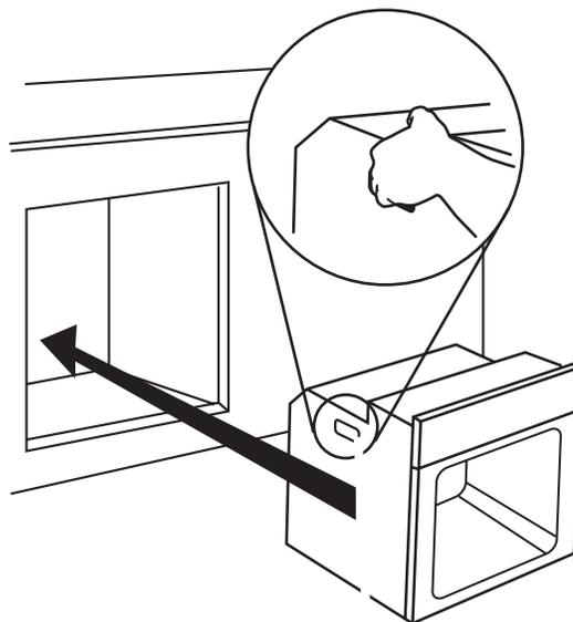
2. Pousser contre la zone du joint de l'avant du châssis pour pousser le four dans l'armoire.
